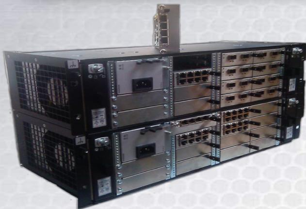
Маршрутизирующий коммутатор «Поток-КМ-2420» предназначен для организации ЛВС на уровне ядра. Изделие имеет модульную архитектуру, состоящий из шасси и набора модулей, с элементами резервирования.
