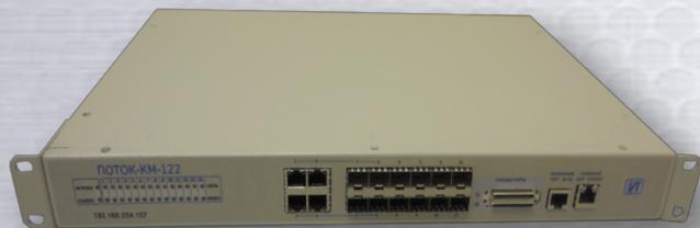
Маршрутизирующий коммутатор «Поток-КМ-122» предназначен для создания маршрутизируемых (иерархических) локальных вычислительных сетей (уровень локальных сетей, узловой, доступа).
